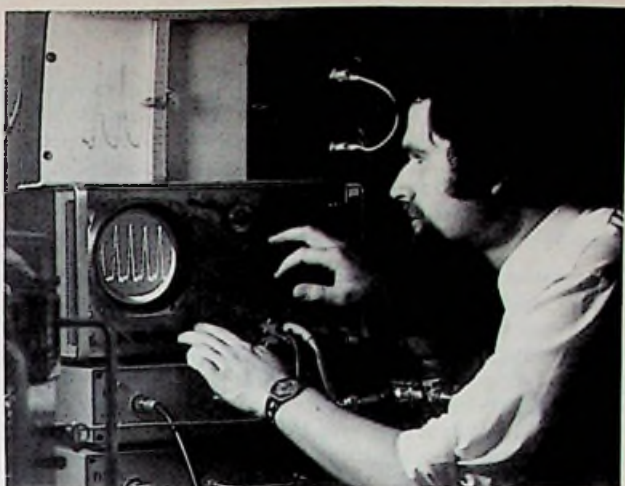
Modulatie van een dubbelhetero-structuur injectielaser met 500 Mbit/s
